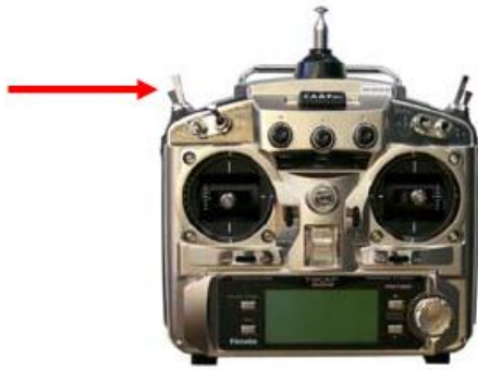
Фиг. 7. Конзола за ръчно управление Futaba 9CAPS
